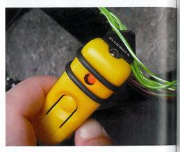
Alles auf Rot: Leuchtet die LED beim Anlegen der Prüfspitze an die Datenbus-Leitung rot, handelt es sich um die CAN-Low-Leitung. Zudem ist der "Bus-Verkehr" über den integrierten Lautsprecher des CANfinder hörbar.
