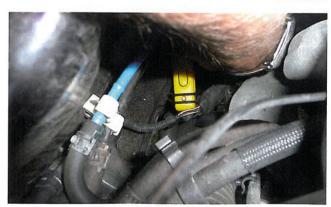
Sonde(n)bar: Mit dem CANfinder lässt sich schnell feststellen, ob die Spannungsversorgung der Lambdasonde funktioniert (LED brennt) und welches das Signalkabel ist (LED blinkt).
