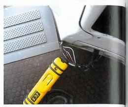
Dauerhaft dunkel: Fließt kein Strom oder ist das Kabel unterbrochen, leuchtet die LED nicht
