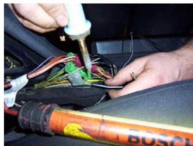
einlöten Blinkerkabel links
