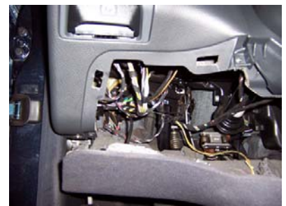
Ausbau Lichtschalter (Stecker)
